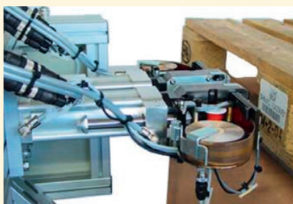
Poste étiquetage : clouage d'étiquettes sur des palettes de bois
