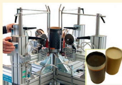
Fermeture par agrafage de tubes en carton, y compris dispositif d'insertion
