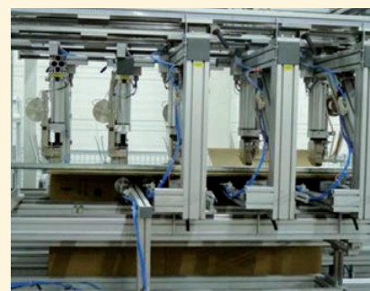
Liaison par agrafage de capuchons pour former une boîte-palette
