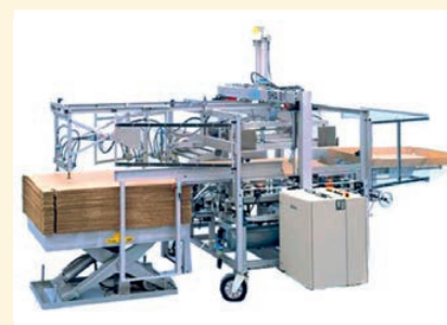
Agrafeuse SHA : agrafage automatique des plateaux intercalaires
