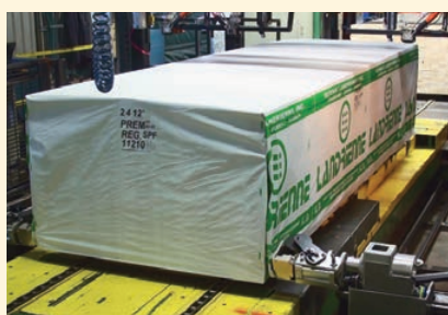
Fixation entièrement automatique d'une bâche de protection sur des découpes de bois
