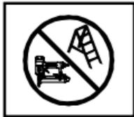
L'emploi des agrafeuses équipées de déclenchement à contact ou de déclenchement permanent avec protection anti-déclenchement et pourvues du symbole "Ne pas utiliser sur échelles ou échafaudages" est interdit dans en haut susmentionné conditions.
