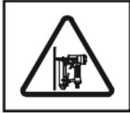
**Danger!** En cas de déclenchement en espace non clos, les objets à enfoncer risquent de voler et l'appareil peut être soumis à une contrainte excessive.
