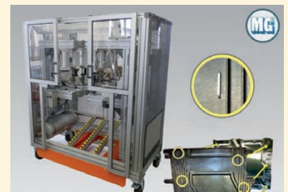
Fixation de tôles d'aluminium sur des habillages en matière plastique
