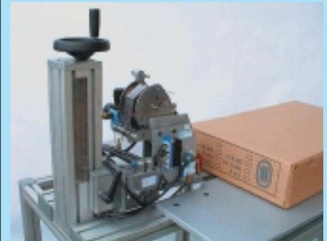
**LRS B/6X** Automatische Heftvorrichtung mit 6 Rollenklammern-Heftköpfen für die Boden- und Deckelheftung von überlappenden Faltschachteln aus Doppelwellpappe.
