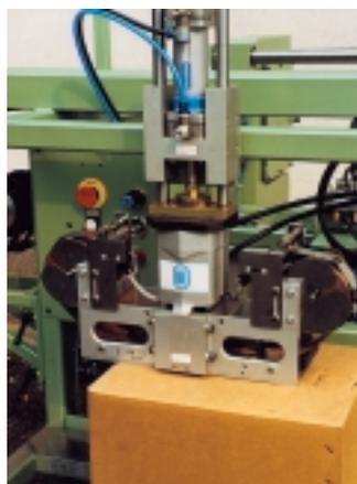
LRW-T Doppel-Heftkopf für die Deckelheftung gefüllter Faltschachteln. Mit Adapterplatte und Zustellzylinder.
