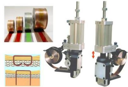
Sur un appui lisse l'agrafe pliée reste au dedans la cannelure la plus basse sans transpercer le papier extérieur, faisant ainsi un agrafage « noyé »
