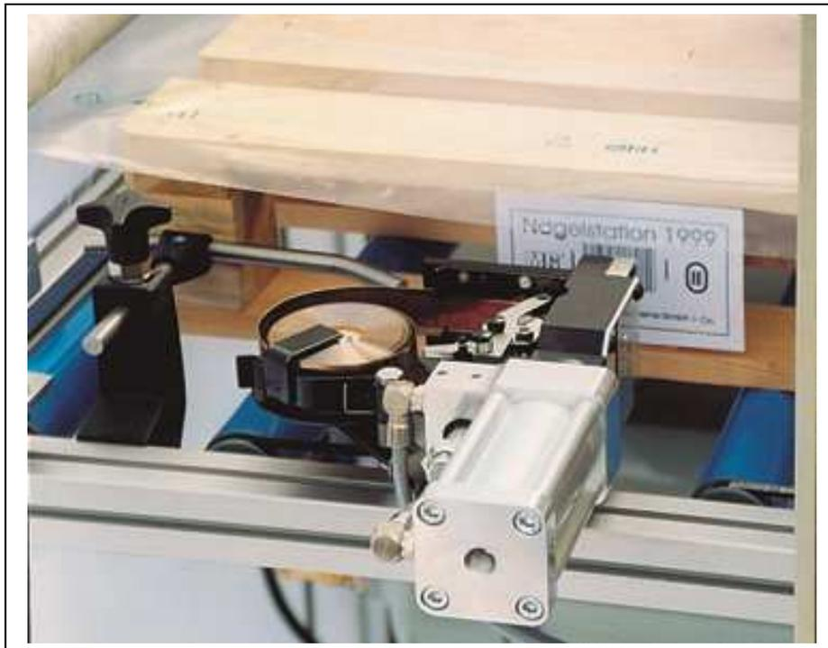
Abb. zeigt linken Rollenklammern-Heftkopf befestigt
