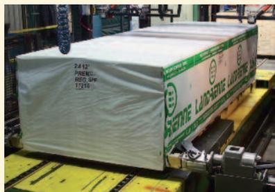
Vollautomatische Fixierung einer Schutzplane an Holzzuschnitten
