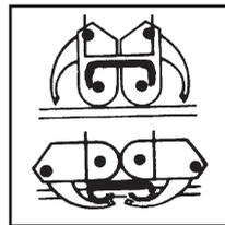
Les agrafes en rouleaux sont recourbées dans le carton par des crochets. Hauteur de perforation réglable.
