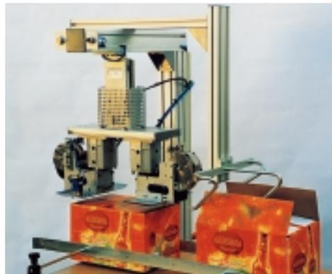
**LRS-T/2** Installation d'agrafage avec 2 têtes agrafeuses pour la fermeture des caisses carton remplies.
