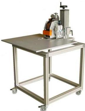
Zusätzlich kann die Tischheftvorrichtung auch auf einem fahrbaren Untergestell montiert werden:
